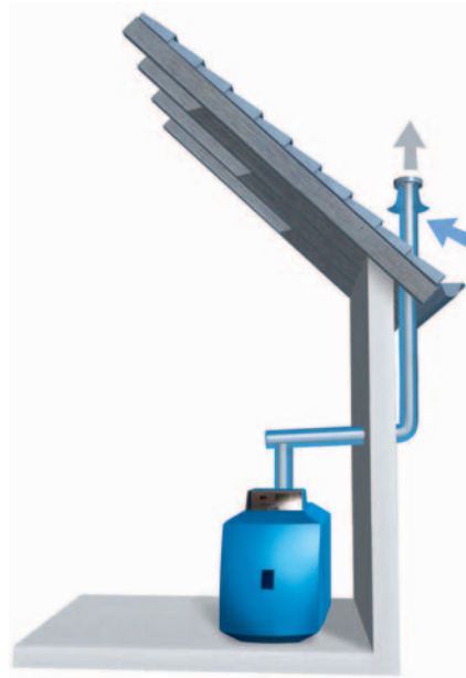
Λειτουργία ανεξάρτητη από τον αέρα του χώρου εγκατάστασης με ομόκεντρο καπναγωγό
